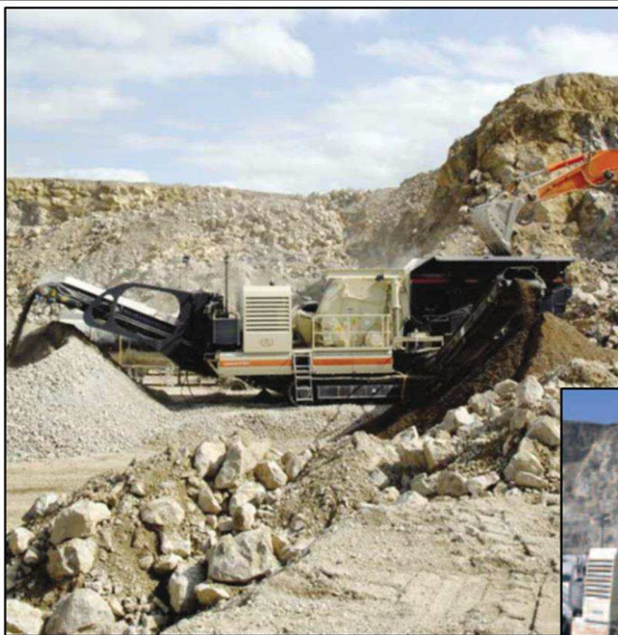
Exemple de groupe mobile de concassage
